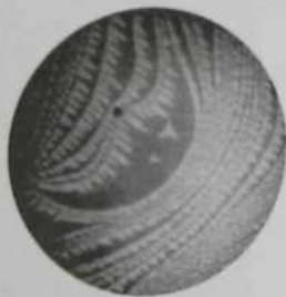
Рис. 6.11. Светлопольное изображение фазового перехода Si(111) 7 \times 7 \rightarrow 1 \times 1 в микроскопе медленных электронов. Фаза 7 \times 7 (светлые участки) декорирует атомные ступени в ходе фазового перехода, тогда как поверхность террас в основном покрыта структурой 1 \times 1 (темные участки). Контраст обусловлен различием структурного фактора рефлекса (0,0) для двух фаз. Размер поля изображения 5 мкм [6.7]
