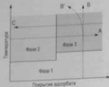
Рис. 8.8. Схематическая фазовая диаграмма. Различные траектории соответствуют: А — осаждению адсорбата при фиксированной температуре; В и В' — изотермному отжигу адсорбата, осажденного при повышенных температурах (с и без десорбции адсорбата соответственно); С — изотермической десорбции адсорбата.
