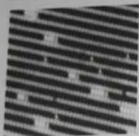
Рис. 7.9. STM изображение поверхности Pt(110) 2 \times 1 после осаждения на нее субмонослойного количества Pt. Осажденные атомы Pt занимают места в канавках структуры отсутствующих рядов [7.14]
