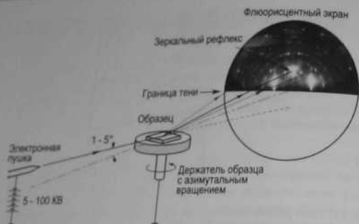
Рис. 3.12. Схема аппаратуры ДВЭ
