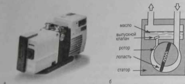
Рис. 2.3. а – Фотография ротационного лопастного насоса фирмы «Alcatel»; б – схематическая диаграмма, иллюстрирующая его принцип действия. Ротор вращается по часовой стрелке
