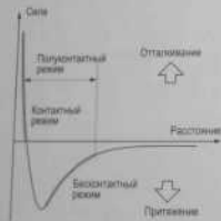
Рис. 6.21. Качественная зависимость силы ван-дер-Ваальса от величины межатомного расстояния. На зависимости отмечены диапазоны расстояний от иглы до образца, используемые для работы АСМ в контактном и бесконтактном режимах
