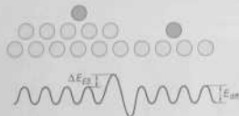
Рис. 13.21. Схематическое изображение потенциального рельефа поверхности вблизи ступени. E_{ES} — барьер Эрлиха-Шюбеля, который адатом (темный кружок) должен преодолеть в дополнение к диффузионному барьеру на террасе для того, чтобы пересечь край ступени и оказаться на нижней террасе [13.13].
