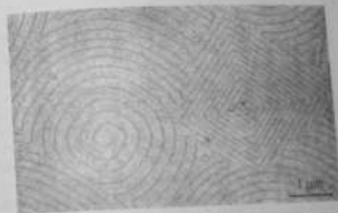
Рис. 9.20. Структура ступеней в точках выхода винтовых дислокаций, полученных сублимацией кристалла NaCl при 400^\circ\text{C} в течение 90 мин в вакууме [9.12]
