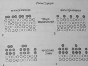
Рис. 7.2. Схематическая иллюстрация возможных типов реконструкций, а и в представляют консервативные реконструкции, то есть случаи, когда концентрация поверхностных атомов сохраняется; б и з представляют неконсервативные реконструкции, то есть случаи, когда концентрация поверхностных атомов уменьшается. На рис. а и б только атомы самого верхнего слоя участвуют в реконструкции; на рис. в и з реконструкция включены атомы нескольких верхних слоев
